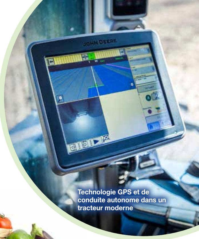
Technologie GPS et de conduite autonome dans un tracteur moderne
