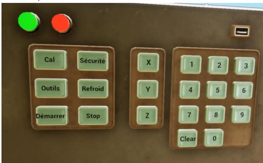
Quand l'explorateur entre une commande en utilisant le clavier, le code réel G&M d'un vrai opérateur CNC va utiliser va être affiché sur l'écran au-dessus. Ceci a été fait pour garder la section de programmer simple et éviter l'explorateur utiliser un grand clavier avec des douzaines de touches, qui peuvent être difficile en RV. Il y a aussi un endroit USB sur le côté droit du bas du panneau de contrôle que l'explorateur va devoir insérer une clé USB pendant le dernier stage de la simulation.
