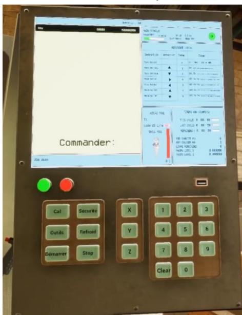
**Écran de pendant de contrôle** : L'écran au-dessus du clavier affiche quelle commande l'explorateur à entrer lorsqu'il avance dans la simulation. Il va aussi mettre à jour et afficher quelle commande est en train d'être active dans la machine CNC lorsque le program à commencer et terminer. Pour montrer que ligne est en train d'être activé, la ligne va être soulignée en couleur noire.
