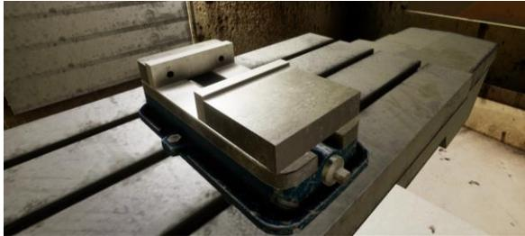
**Poignet de Vice** : Le poignet du vice est sur le banc de travail. Elle est utilisé pour barré ou débarré le vice. Lorsque le poignet du vice est placé sur le vice, en le tournant vers la droite ou dans le sens des aiguilles d'un montre, va barrer le vice et le tourner vers la gauche ou dans le sens contre les aiguilles d'un montre va débarrer le vice. Pour retirer le poignet de viser, prend et retire hors du vice et elle va décharger.
