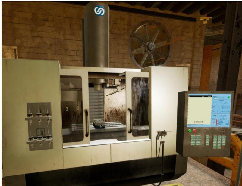
**Pendant de Contrôle** : Le pendant de contrôle sont un grand clavier et écran qui est attaché au côté droit du machin CNC. Ceci est où l'explorateur va passer la majorité du simulation, car il va devoir donner plusieurs différents commands de cet endroit.
