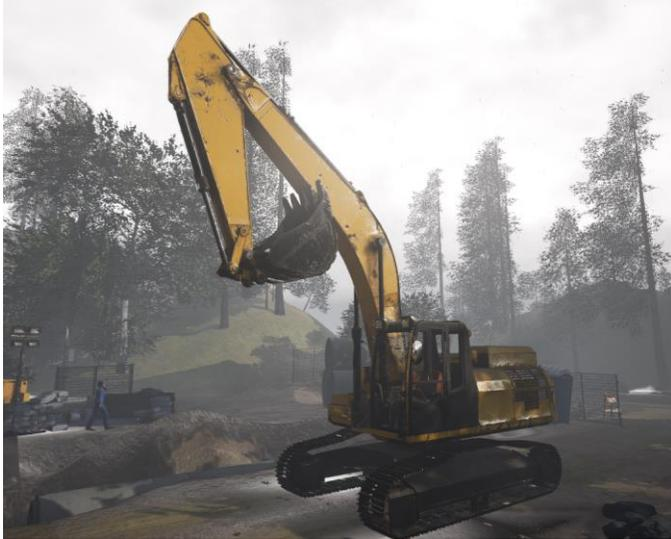
**Manette du godet gauche** : En la poussant vers l'avant, loin de l'utilisateur, on éloigne le godet. En la tirant vers l'arrière, vers l'utilisateur, on enfonce le godet. En l'inclinant vers la gauche ou vers la droite, on fait tourner la cabine de la pelleuse dans cette direction.
