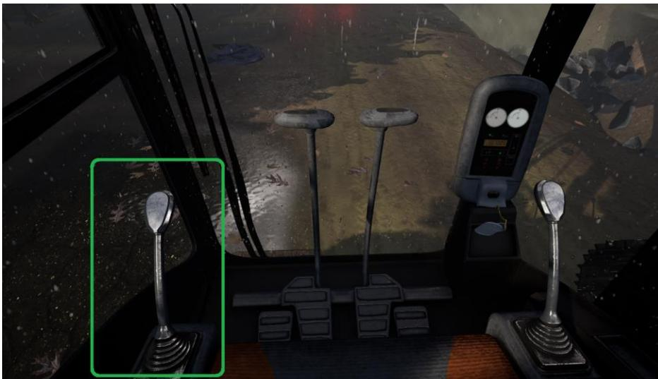
**Manette du godet droite** : En la poussant vers l'avant, loin de l'utilisateur, on fait descendre la flèche. En la tirant vers l'arrière, vers l'utilisateur, la flèche se déplace vers le haut. En l'inclinant vers la droite, le godet se replie vers l'intérieur. En l'inclinant vers la gauche, on déploie le godet.
